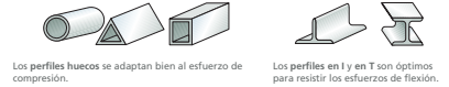
Los perfiles huecos se adaptan bien al esfuerzo de compresión. Los perfiles en I y en T son óptimos para resistir los esfuerzos de flexión.
